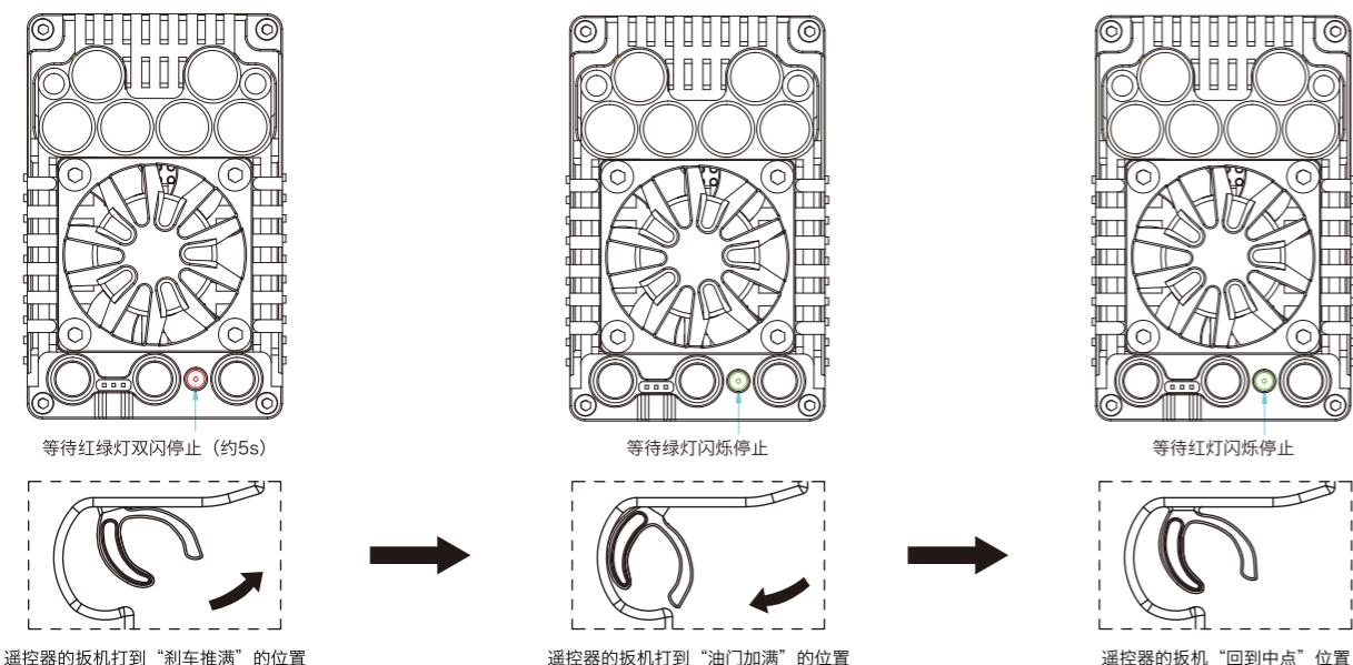
1. 电调关机->正方向，油门和刹车调到100%行程->扳机打到“刹车推满”的位置并保持->上电->等待红绿灯双闪停止(约5s)。
